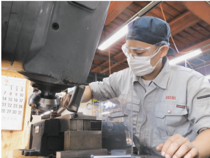
フライス加工機にワークを固定するファン・ タイン・フン氏
